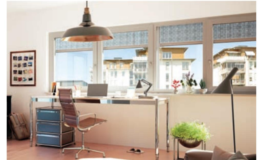
Der textile Sonnenschutz wird vor dem Fenster montiert. Je nach gewähltem Gewebe kann damit ein lichtdurchlässiger oder ein blickdichter Sonnenschutz geschaffen werden. Das Textil reflektiert und absorbiert das Sonnenlicht, wodurch die Sonneneinstrahlung um bis zu 100 % reduziert wird, ohne dass auf natürliches Tageslicht verzichtet werden muss. Gleichzeitig wird die UV-Strahlung um bis zu 100 % gefiltert.
