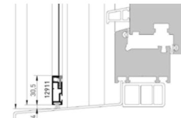
heroal IS Spannrahmen vor Rollladenschienen oben und unten mit Bürste
